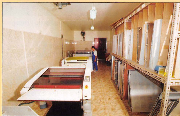
Sviluppatrici automatiche di lastre per la stampa.
