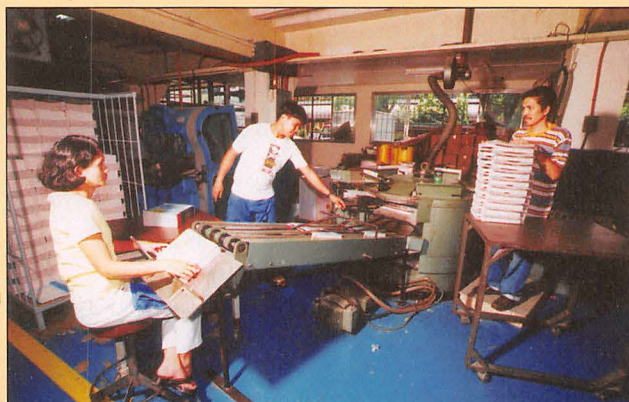
Brossatrice circolare per la copertinatura dei volumi.
