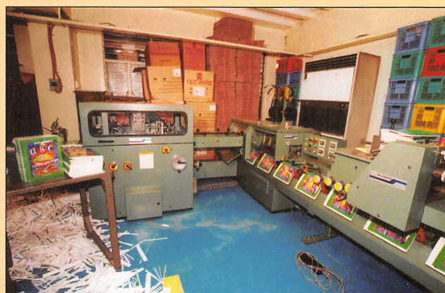
Accavallatrice/cucitrice a punto metallico con trilaterale per il rifilo dei fascicoli.
