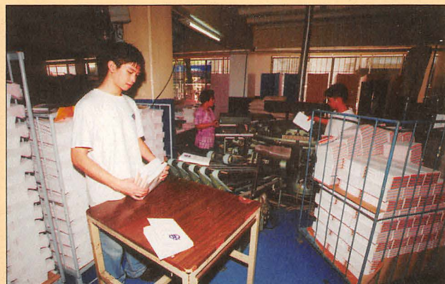
Brossatrice circolare. Incollatura del libro e applicazione della copertina.
