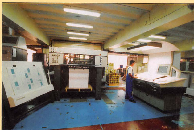
Tavolo di comando e di controllo su macchina da stampa.
