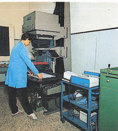
Ingranditore con programmatore per la retinatura degli originali
