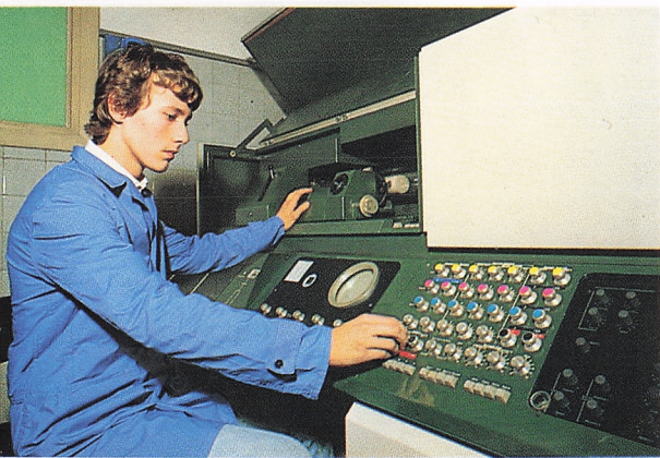
Scanner: apparecchiatura per la selezione elettronica degli originali a colori
