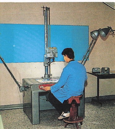
Riproduttore microfilm per originali opachi e trasparenti
